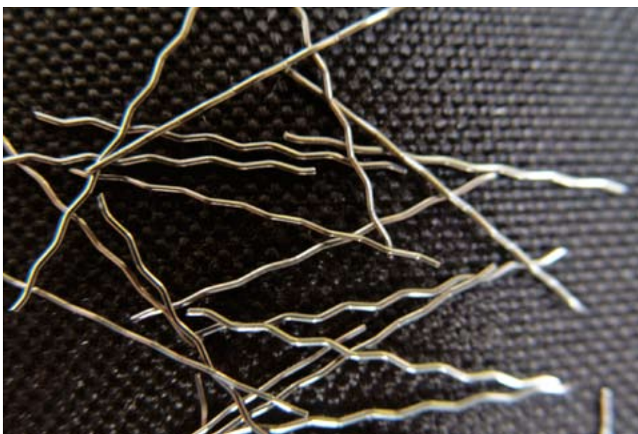
Obr. 1: Typické oceľové vlákna zakončené kotevným háčikom
