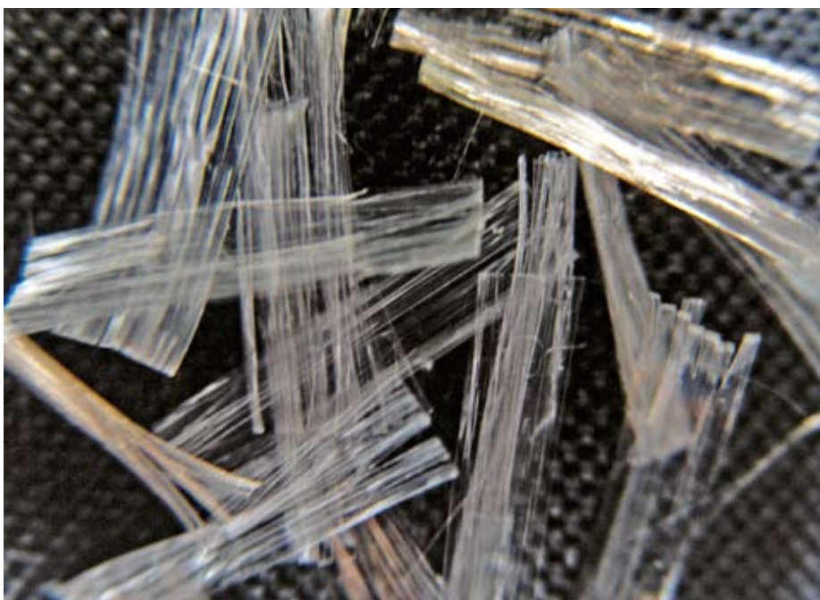
Obr. 2: Typické polypropylénové fibrilované vlákna
