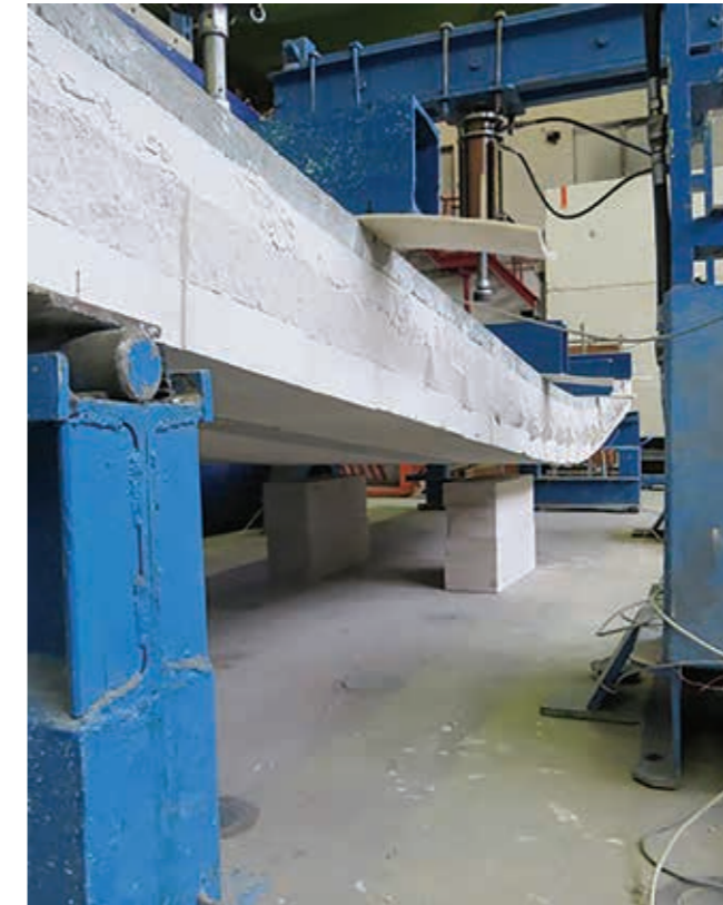
■ Zaťažovacia skúška stropnej konštrukcie z betónových nosníkov a vložiek / Load test of ceiling structure consisting of concrete beams and block ceiling system
