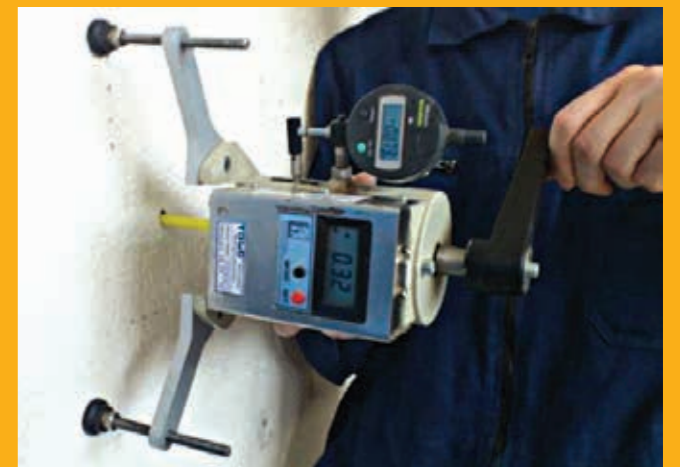
■ Výtlačná skúška rozperných kotiev / Pull-out test of plastic screw anchors
