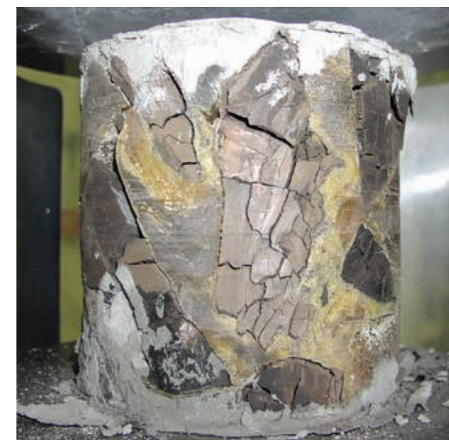
■ Skúška pevnosti v tlaku injektovanej horniny / Pressure strength test of injected rock
