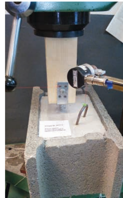
■ Skúška únosnosti ocelových spojok podľa ETAG 015 / Test of load bearing capacity of steel couplings according to ETAG 015
