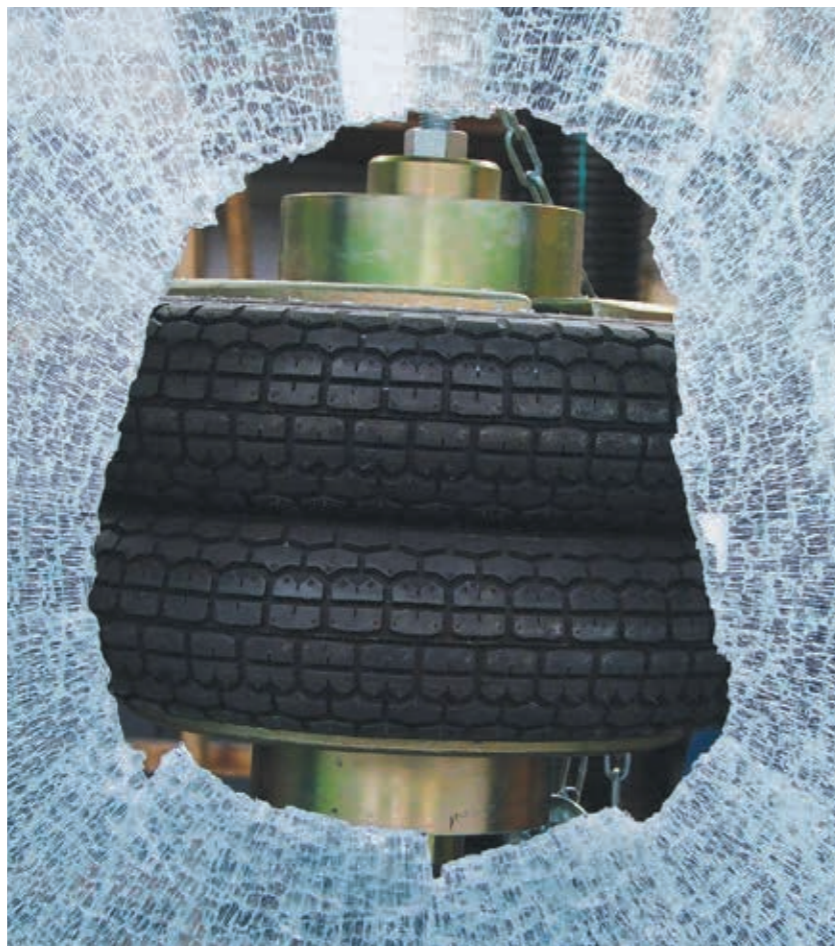
■ Sklo - Kyvadlová skúška EN 12600 / Glass – Pendulum test according to EN 12600
