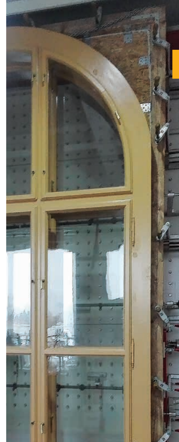
■ Simulovanie poveternostných vplyvov na veľkorozmernom okne Národného múzea v Prahe / Simulation of weather influences on the large-scale window of the National museum in Prague
