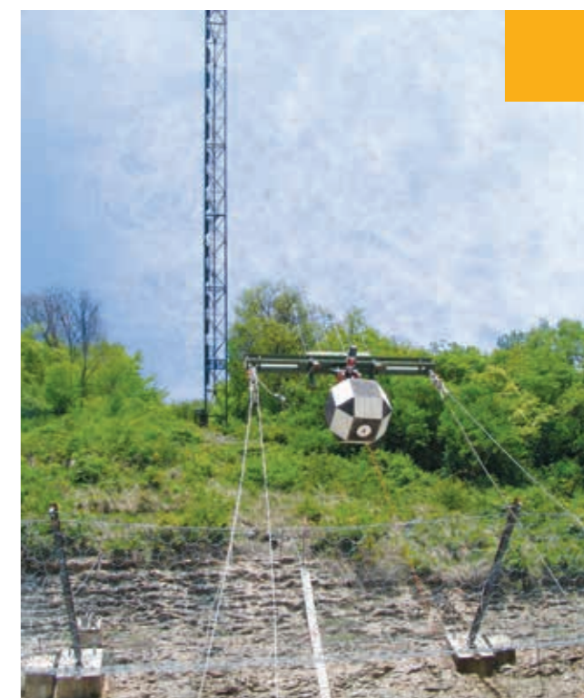
■ Nárazová skúška bariér proti padajúcim skalám / Impact test of rockfall protection barriers
