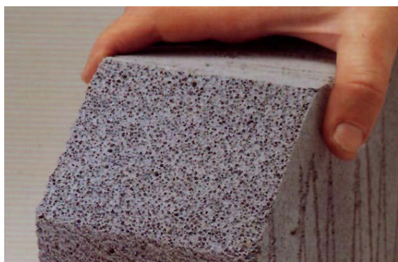
Obrázok 7: Rez pórobetónovým prvkom odhaľujúci pórú štruktúru [26]
