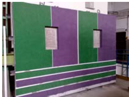
Obr. 2: Skúšobná vzorka – stena rozmerov 3,44 x 2,44 m.
