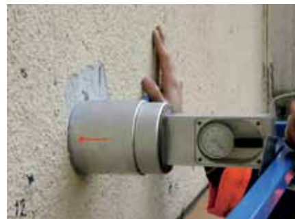
Obr. 4 Nedeštruktívna skúška pevnosti v tlaku Hanečkovej metódou
