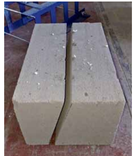
Obr. 7 Vzorka s trhlinou sklonenou o 15°
