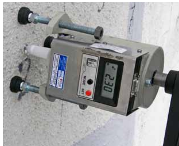
Obr. 6: Výťažná skúška príchytky
