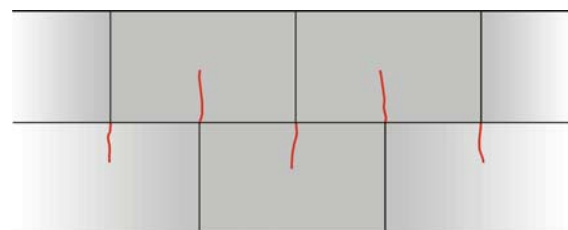
Obr. 10 Trhliny od nedostatočného odseparovania betónovaných pásov [5]
