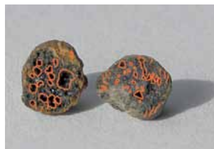
Obr. 11 Zrná ľahkého kameniva Liapor (vľavo uzavretá štruktúra, vpravo otvorená štruktúra)
