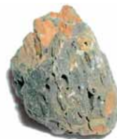
Obr. 10 Pórová štruktúra ľahkého kameniva (USA)
