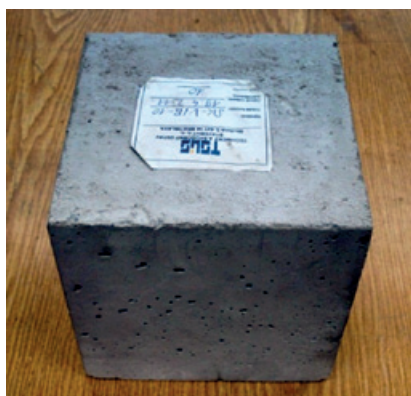
Obrázok 5. 4. 9 Pôvodná kocka a rezy veľkosti 150 x 150 x 75 mm pre skúšky pevnosti v tlaku
