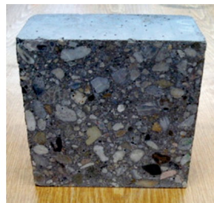
Obrázok 5. 4. 9 Pôvodná kocka a rezy veľkosti 150 x 150 x 75 mm pre skúšky pevnosti v tlaku
