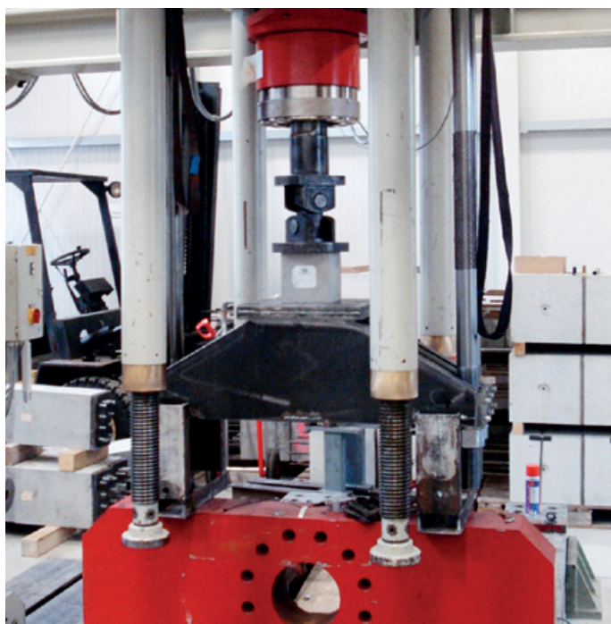
Obrázok 5. 4. 41 Usporiadanie skúšobného zariadenia pre dynamické skúšky Abbildung 5. 4. 41 Versuchsanordnung für dynamische Versuche
