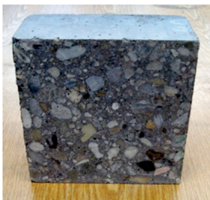
Obrázok 5. 4. 9 Pôvodná kocka a rezy veľkosti 150 x 150 x 75 mm pre skúšky pevnosti v tlaku
