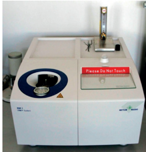
Obrázok 5. 5. 28 Diferenciálny skenovací kalorimeter Abbildung 5. 5. 28 Die Differenzkalorimetrie Gerät
