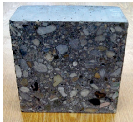
Obrázok 5. 4. 18 Preznanie skúšobných vzoriek na polovicu Abbildung 5. 4. 18 Halbieren der Würfelproben
