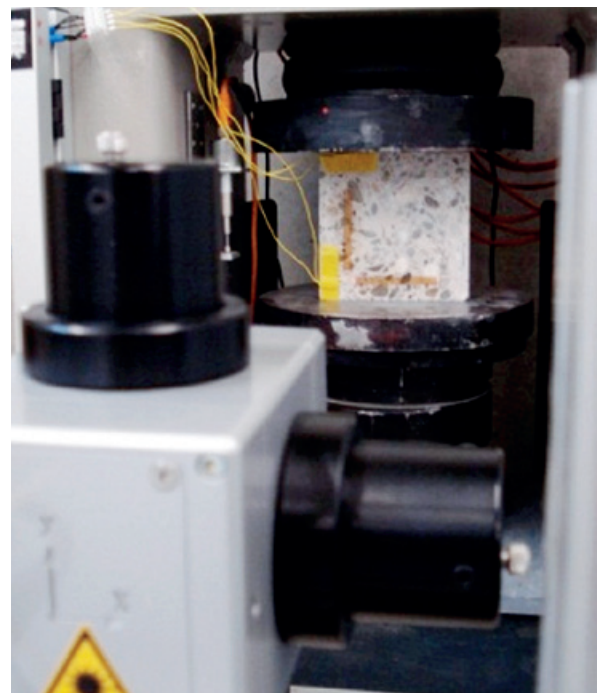
Obrázok 5. 4. 29 Paralelné meranie ESPI a DMS Abbildung 5. 4. 29 Parallelmessungen ESPI und DMS
