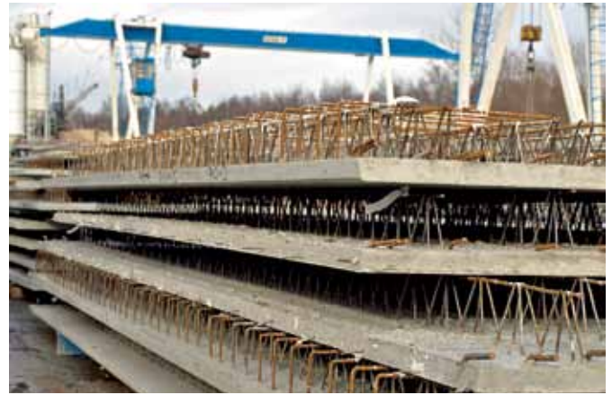
Obr. 5 Stratené debnenie – filigranové dosky
