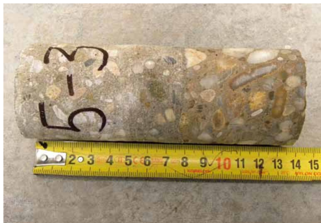
Obr. 7 Nadbetónovanie pôvodnej sfrézovanej podlahy vrstvou s viditeľne menším Dmax
