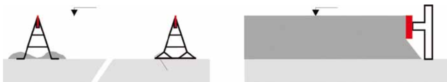
Obr. 5 Betonáž pomocou bočnic a visutých vodiacich líšť
